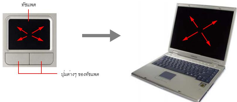
ทัชแพดที่เครื่องคอมพิวเตอร์ของคุณช่วยให้คุณสามารถเลื่อนพอยน์เตอร์ไปมาบนจอ LCD ได้ เช่นเดียวกับการใช้ม้าส์เพื่อเลื่อนในเครื่องเดสก์ท็อป บุมของทัชแพดช่วยให้คุณสามารถสั่งงานพอยน์เตอร์ได้ เช่น การเลือกรายการหรือการใช้คำสั่ง
