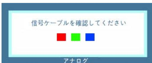
いずれかの表示に異常があれば、モニタが正しく動作していない可能性があります。この表示は、ビデオケーブルが未接続または損傷している場合にも表示されます。
