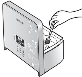
**주의** 절대로 화학약품이나 일반세제 등으로 청소하지 마세요. 진동자 표면을 손가락으로 문지르거나, 날카로운 물건으로 긁으면 분무가 약해지거나 고장의 원인이 됩니다. 본체 내부 청소시 송풍구로 물이 들어가지 않도록 주의하세요. (누전 및 감전의 위험이 있을 수 있습니다.)
