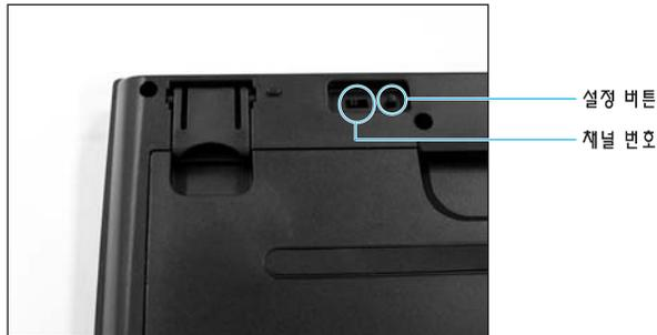
3. 무선 마우스 밑면의 배터리 덮개를 뺀 후 배터리를 빼고 채널 번호를 1 또는 2번으로 맞추는 후 배터리를 다시 끼웁니다.
