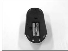
**참고** : 무선 키보드에는 AA 타입의 일반 알카라인 건전지를 사용하시고, 무선 마우스는 반드시 함께 제공되는 니켈-수소(Ni-MH) 타입의 충전용 배터리를 사용하십시오.
