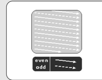
하나의 화면을 주사하는데 한줄(Field) 건너 두번의 주사로 전체의 화면(Frame)을 주사하는 방식입니다. 1화째는 옆 그림의 실선(Even Field)과 같이 주사하고, 두번째는 점선(Old Field)과 같이 주사하여 하나의 화면(Frame)을 만듭니다. 예를 들면, 1 초간에 30매의 상(30 frame)을 보내도 실제로는 60매의 거친 상(60 field)을 보낸 것이 되며, 움직이는 대상을 촬영해서 보낼 때는 마치 2개의 영상이 겹쳐진 듯한 화면이 보입니다. 보통 정지된 대상을 처리할 때 사용하는 방식으로 비월주사 방식이라고 합니다.
