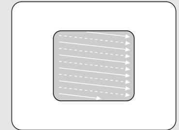
하나의 화면을 주사하는데 한번의 주사로 전체의 화면(Frame)을 주사하는 방식으로 순차적 주사 방식입니다. 비월주사 방식이 2개의 Field를 주사하는 반면, 순차주사 방식은 한번의 주사로 하나의 화면을 만듭니다. 이러한 성능의 Camera를 Full Frame Shutter Camera라고도 합니다. 이러한 특성을 이용하여 움직이는 대상을 정지시키지 않고 촬영하여 처리할 때 사용되는 방식입니다.
