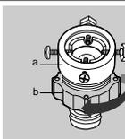
3. 將連接器套住水龍頭並上緊螺絲，如圖按箭頭方向旋轉(b)部份，使(a)(b)擰緊
