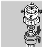
2. 首先，用[+]字起子鬆開4個螺絲，然後抓住連接器，如圖按箭頭方向旋轉(b)部份，直到5mm的縫隙
