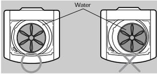
1. 先水平地調整機身的一側，然後再以相同的方向調整前面。
