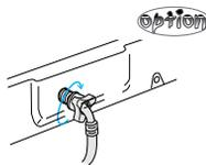
5. 將進水管的另一端連接到洗衣機後面的進水閥。沿順時針方向將水管旋到底。
