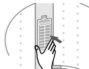
4. 關上護蓋，先將過濾器底部插入洗衣槽內，再將過濾網壓入到位。
