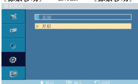
使用此功能后，LCD 上的像素每分钟都以水平或垂直方向移动，从而可防止屏幕上出现残留影像。
