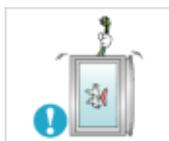
▶ 请勿尝试仅通过拉线缆或信号线缆来移动显示器。
