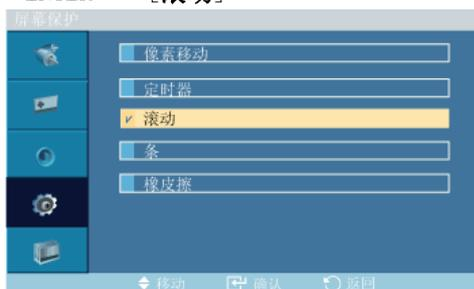
使用此功能可按照一种图案移动 LCD 上的所有像素，从而防止屏幕上出现残留影像。
