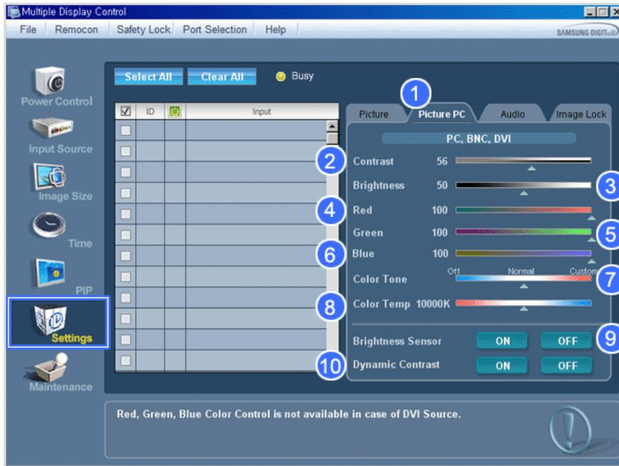
\* 信息窗格显示设置控制所需的某些基本信息。选定了每项功能后，所选功能的设置值显示在滑块上。选定后，每项功能都取设定值并显示在滑块上。选择“Select All”（全选）后，显示默认值。更改此屏幕中的一个值，将会自动更改为 CUSTOM（个人设定）模式。
