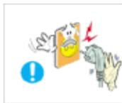
▶ 将电源插头拔出或插入电源插座时，请勿用湿手触碰电源插头。
