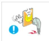
▶ 请勿使用破损的电源线或电源插头以及破损或松动的电源插座。
