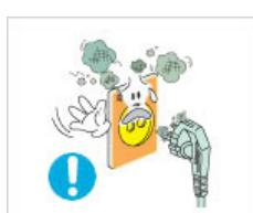
● 请勿在连接器或插头积尘的情况下使用电源线。
