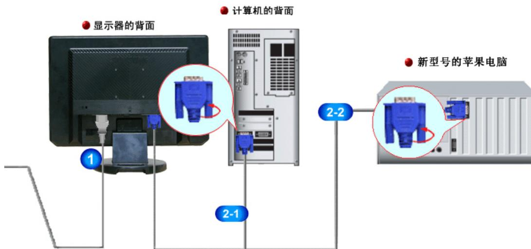
1. 请把显示器的电源插到显示器背后的电源端口上。
