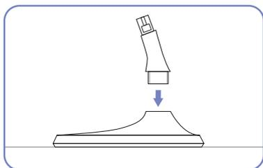
如圖所示，將支架連接器從合適方向插入支架。
