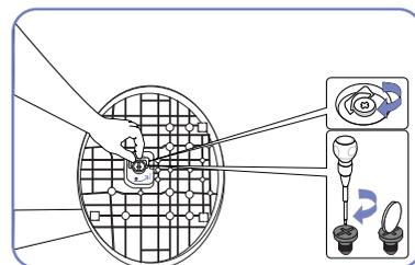
旋轉支架底部的連接螺絲，直至完全固定到位。
