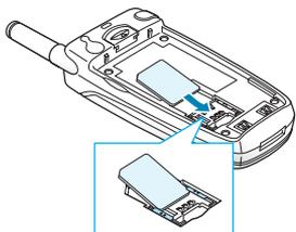
**註：**需要取出SIM咭時，如圖所示，輕輕滑出卡架。
