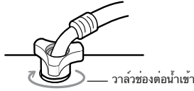
2. ดันเครื่องกรองเข้าและต่อท่อเข้ากับ วาล์วช่องต่อหน้าเข้าให้แน่น
