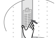
4. ปิดฝาครอบและใส่ส่วนล่างของดงกรองไว้ในดังก่อน จากนั้นจึงดงกรองเข้าไปจนได้ยินเสียงดัง "คลิก"
