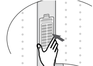
4. ปิดผ้าครอบและใส่ส่วนล่างของตู้กรองไว้ในถังก่อน จากนั้นจึงดึงกรองเขาไปจนได้ยินเสียงดัง "คลิก"
