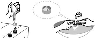
1. ดึงตัวกรองออกแล้วล้าง ให้สะอาด(เพื่อป้องกัน การอุดตันของตัวกรอง ควรจะทำการถอด ล้างทุกๆสองอาทิตย์)
