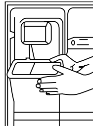
เมื่อต้องการถอดถังน้ำออกมาทำความสะอาดให้ยกถังน้ำขึ้นแล้วเอียงออกทางด้านขวา (หลังจากถอดท่อน้ำออกไปแล้ว)
