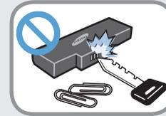
**Achten Sie darauf, dass keine Metallgegenstände wie Schlüssel oder Büroklammern die Batterieklemmen (Metallteile) berühren.**
