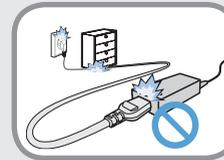
**Um zu verhindern, dass Netzteil oder Netzkabel beschädigt werden, dürfen Sie keine schweren Gegenstände darauf stellen oder darauf treten.**
