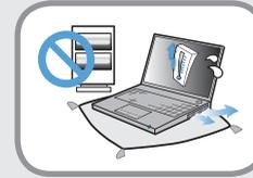
**Verwenden Sie den Computer nicht an schlecht belüfteten Stellen (im Bett, auf einem Kopfkissen oder Polster usw.) und stellen Sie ihn im Betrieb in Räumen mit Fußbodenheizung nicht auf den Boden, da sich der Computer dadurch überhitzen könnte.**
