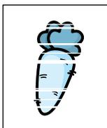
Die Druckqualität kann durch eine Reinigung der Druckdüsen der Tintenkartusche verbessert werden. Wenn auf der gedruckten Seite Zeilen oder Bildpunkte fehlen oder wenn Schlieren vorhanden sind, sollten Sie die Tintenkartusche wie in diesem Abschnitt beschrieben reinigen.
