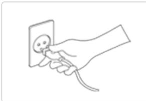
▶ Halten Sie den Stecker beim Abziehen aus der Steckdose am Gehäuse fest, denn durch Ziehen am Kabel kann es beschädigt werden.
