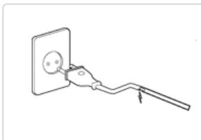
▶ Verwenden Sie keine beschädigten Stecker, Kabel oder Steckdosen, denn dadurch können Stromschläge oder Brände verursacht werden.
