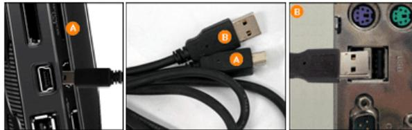
**A** Stellen Sie eine Verbindung zum Computeranschluss des digitalen Bilderrahmens her.
