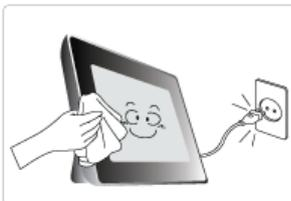
▶ Ziehen Sie das Netzkabel ab, bevor Sie das Gerät reinigen.
