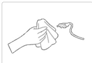
▶ **Entfernen Sie regelmäßig Schmutz und Wasser von den Stiften und Anschlüssen des Netzsteckers.**
