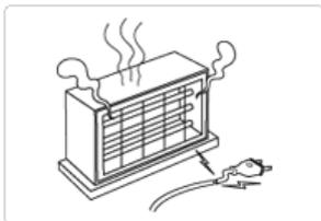
▶ Stellen Sie das Netzteil nicht in der Nähe von Heizkörpern auf, denn dadurch kann das Kabel schmelzen, und es kann zu Stromschlägen oder Bränden kommen.
