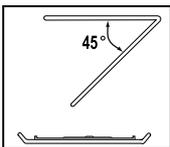
Wenn Sie die Oberseite im Garraum reinigen, ist es ratsam, den Grill um 45° nach unten zu drehen und zu reinigen.
