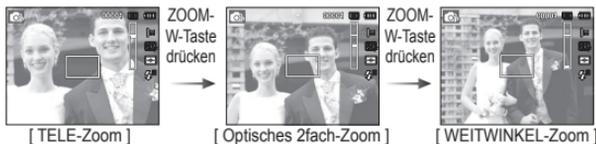
Digitaler WEITWINKEL-Zoom : Ist der Digitalzoom in Betrieb, wird durch Drücken der Zoomtaste W der digitale Zoom schrittweise verringert. Wird die Taste ZOOM W losgelassen, wird der Digitalzoom gestoppt. Durch Drücken der ZOOM-W-Taste werden erst das Digitalzoom und anschließend das optische Zoom verringert, bis die minimale Einstellung erreicht ist.
