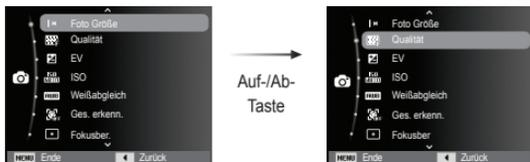
4. Wählen Sie das gewünschte Untermenü mit der Links-/Rechts-Taste und drücken Sie anschließend OK.
