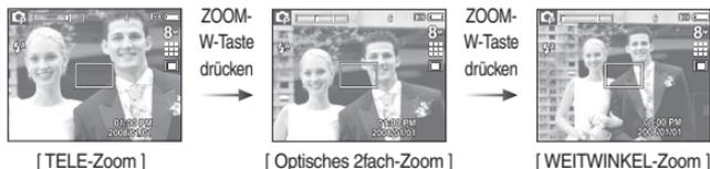
Digitaler WEITWINKEL-Zoom : Ist der Digitalzoom in Betrieb, wird durch Drücken der Zoomtaste W der digitale Zoom schrittweise verringert. Wird die Taste ZOOM W losgelassen, wird der Digitalzoom gestoppt. Durch Drücken der ZOOM-W-Taste werden erst das Digitalzoom und anschließend das optische Zoom verringert, bis die minimale Einstellung erreicht ist.
