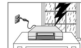
Bei einem Sturm oder Gewitter den DVD-VCR von der Netz-steckdose und der Antennen-steckdose trennen. Andernfalls kann das Gerät Schäden nehmen, falls durch Blitzeinschlag Überspannungen im Leitungsnetz auftreten.
