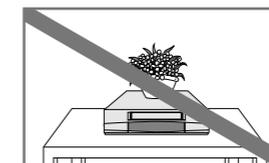
KEINE Gegenstände auf den DVD-VCR oder die Fernbedienung stellen. Fremdkörper, die in das Gerät eindringen, können einen Kurzschluss und dadurch Schäden verursachen. Falls Belüftungsöffnungen abgedeckt werden, kann es zum Überhitzen und zu Funktionsstörungen kommen.
