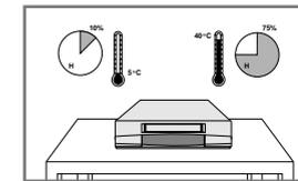
Den DVD-VCR NICHT extremen Temperaturen (unter 5°C und über 40°C) oder extremen Feuchtigkeitsbedingungen (weniger als 10 % und mehr als 75 %) aussetzen. Hohe Temperaturen können zum Kondensieren und zu Funktionsstörungen und Schäden führen.
