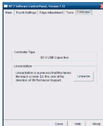
Die Registerkarte **Controller** bietet verschiedene Einstellmöglichkeiten. Welche Möglichkeiten Ihnen hier geboten werden, richtet sich nach der Art des Berührungssensors, den Sie an Ihr System angeschlossen haben, und nach den Optionen, die Sie auf der Registerkarte **Tools** mit **Advanced Options** gewählt haben.
