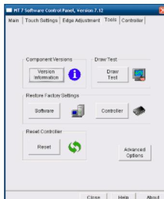
Mit der Registerkarte **Tools** können Sie verschiedene Diagnosen durchführen, um die Leistung des Berührungssensors zu optimieren. Diese Registerkarte ist zugleich der Zugang zu den erweiterten Berührungsoptionen.
