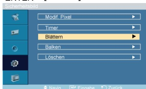
Diese Funktion verhindert Nachbilder auf dem Bildschirm, indem sie alle Pixel des LCD-Bildschirms nach einem bestimmten Muster verschiebt.
