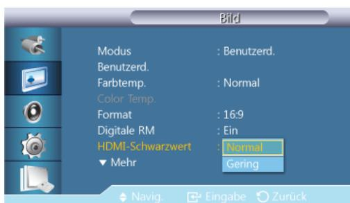
Wenn Sie eine DVD oder Set-Top-Box über HDMI an Ihr Fernsehgerät anschließen, kann es zu einer Verschlechterung der Bildqualität kommen. Dies drückt sich, je nach angeschlossenen externen Gerät, in einer Zunahme des Schwarzwertes, geringem Kontrast und Farbfehlern usw. aus. Stellen Sie in diesem Fall die Bildqualität des Fernsehgeräts ein, indem Sie den **HDMI-Schwarzwert** konfigurieren.
