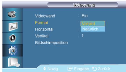
Das **Format** kann ausgewählt werden, um ein segmentiertes Bild anzuzeigen.
