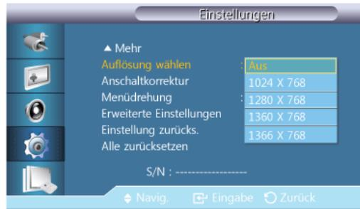
Wenn das Bild bei einer Einstellung der Grafikkartenauflösung auf **1024 x 768 bei 60 Hz**, **1280 x 768 bei 60 Hz**, **1360 x 768 bei 60 Hz** oder **1366 x 768 bei 60 Hz** nicht ordnungsgemäß angezeigt wird, können Sie mit dieser Funktion (Resolution Select) dafür sorgen, dass das Bild in der angegebenen Auflösung angezeigt wird.
