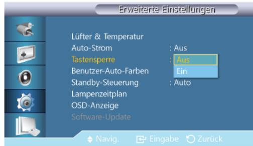
Sperren bzw. Freigeben der Monitor-Bedientasten am Gerät.
