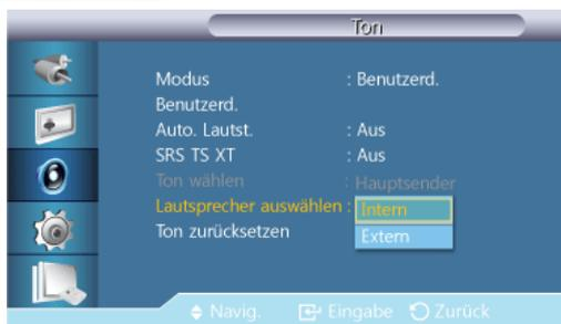
Wenn Sie das Gerät verwenden, während es an ein Heimkinosystem angeschlossen ist, schalten Sie die eingebauten Lautsprecher aus, damit Sie nur den Ton der (externen) Lautsprecher des Heimkinosystems hören.
