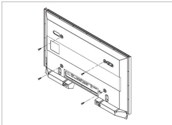
2. Setzen Sie die Schraube B in das Hängelager ein.
