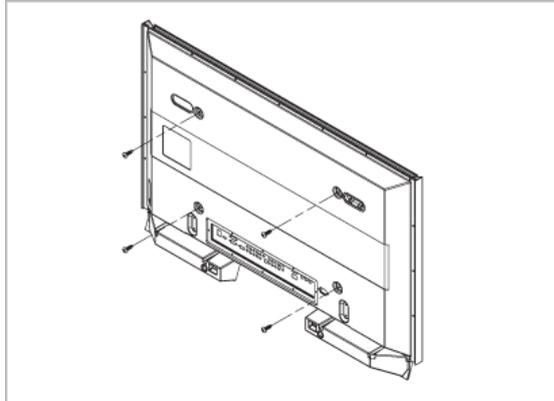
4. Entfernen Sie den Sicherheitsstift (3), und setzen Sie die 4 Gerätehalterungen in die entsprechenden Bohrungen in der Wandhalterung (1) ein. Setzen Sie anschließend das Gerät (2) so ein, dass es fest mit der Wandhalterung verbunden ist. Setzen Sie den Sicherheitsstift (3) wieder ein, und ziehen Sie ihn fest, damit das Gerät an der Wandhalterung sicher fixiert ist.
