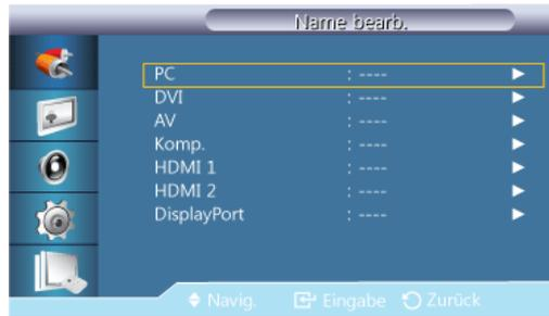
Vergeben Sie an das an die Eingangsbuchsen angeschlossene Eingabegerät einen Namen, um die Auswahl der Signalquelle zu vereinfachen.
