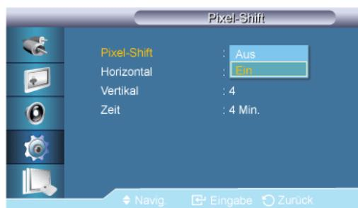
Um Nachbilder auf dem Bildschirm zu verhindern, können Sie mit dieser Funktion dafür sorgen, dass die Pixel auf dem LCD-Bildschirm horizontal oder vertikal verschoben werden.
