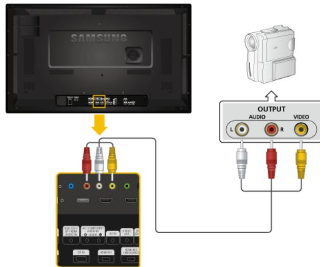
1. Suchen Sie die AV-Ausgangsbuchsen am Camcorder. Sie befinden sich normalerweise seitlich am Camcorder oder auf dessen Rückseite. Verbinden Sie den [AV IN]-Eingang am LCD-Bildschirm mit dem VIDEO OUTPUT-Anschluss am Camcorder.
