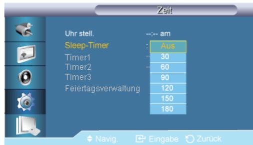
Hiermit wird der LCD-Monitor zu einer bestimmten Zeit automatisch ausgeschaltet.
