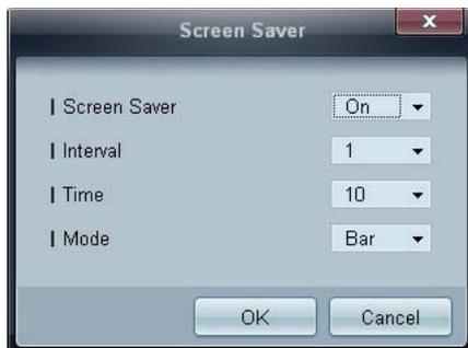
Diese Funktion verhindert das Einbrennen, wenn der Bildschirm des ausgewählten Anzeigeräts für einen längeren Zeitraum nicht verwendet wird.
