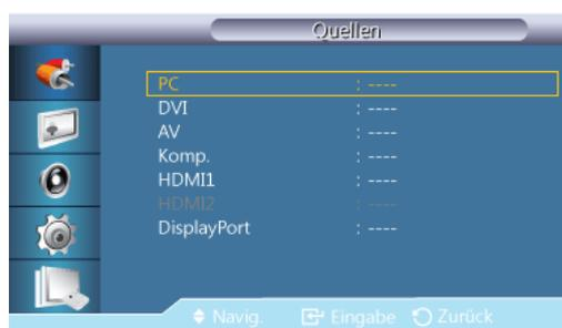
Dient zum Auswählen von **PC**, **HDMI** oder einer anderen an den LCD-Bildschirm angeschlossenen externen Signalquelle. Wählen Sie hiermit den gewünschten Bildschirm aus.
