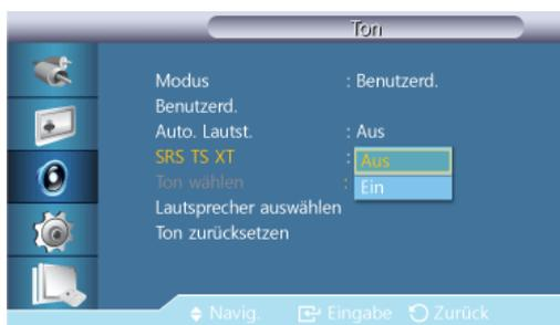
**SRS TS XT** ist ein patentiertes SRS-Verfahren für die Wiedergabe von 5.1-Mehrkanalton über zwei Lautsprecher. Mit TruSurround XT kommen Sie in den Genuss überzeugender Virtual-Surround-Effekte über alle Stereo-Systeme mit zwei Lautsprechern, einschließlich interner Fernsehlautsprecher. Es ist vollständig kompatibel mit allen Mehrkanalformaten.
