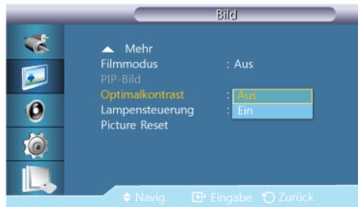
Mit der Funktion **Optimalkontrast** wird das eingehende Bildsignal ausgewertet und so eingestellt, dass ein optimaler Kontrast erzielt wird.
