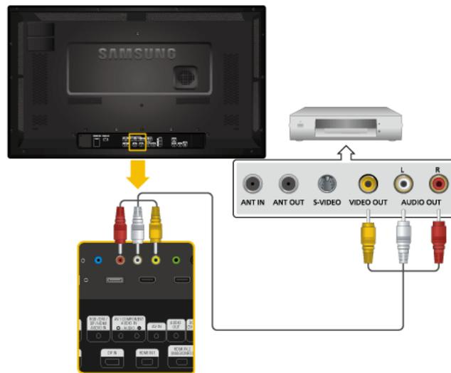
1. Schließen Sie den [AV/COMPONENT AUDIO IN (R-AUDIO-L)]-Anschluss des Geräts mithilfe eines Stereokabels am Audioanschluss eines externen Geräts (z. B. Videorekorder oder DVD-Player) an.
