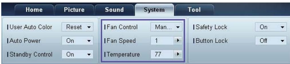
Konfiguriert die Einstellungen, die zur Erkennung der Lüfterdrehzahl und Innentemperatur zum Schutz des Geräts erforderlich sind.
