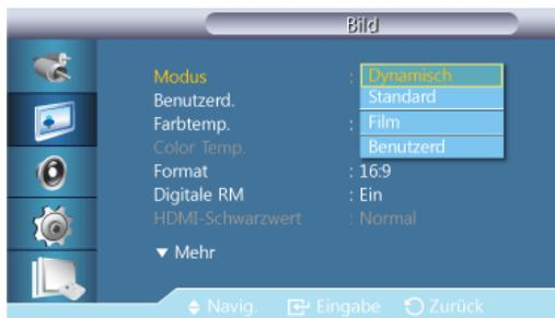
Der LCD-Bildschirm verfügt über vier automatische Bildeinstellungen ("Dynamisch", "Standard", "Film" und "Benutzerd."), die werksseitig eingestellt werden.
