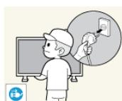
▶ Wenn Sie das Gerät transportieren müssen, schalten Sie es ab, ziehen Sie den Netzstecker sowie das Antennenkabel und alle anderen daran angeschlossenen Kabel.
