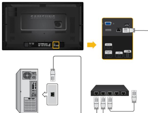
Stellen Sie mit einem LAN-Kabel die Verbindung zwischen dem [*LAN*]-Anschluss des Geräts und dem [*LAN*] Ihres PCs her.
