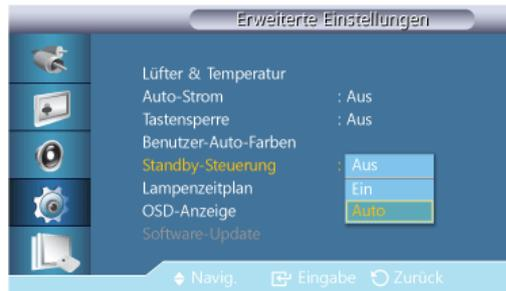
Einstellen des Standbymodus, der ausgelöst wird, wenn kein Eingangssignal festgestellt wird.
