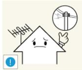
▶ Installieren Sie die Antenne in größerer Entfernung von Hochspannungskabeln.
