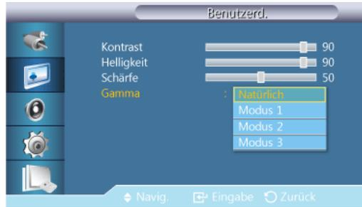
Einstellen der Helligkeit im mittleren Bereich (Gamma) des Bilds.
