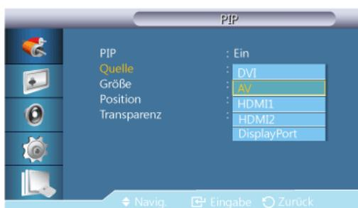
Hiermit wählen Sie die Signalquelle für die PIP-Funktion aus.
