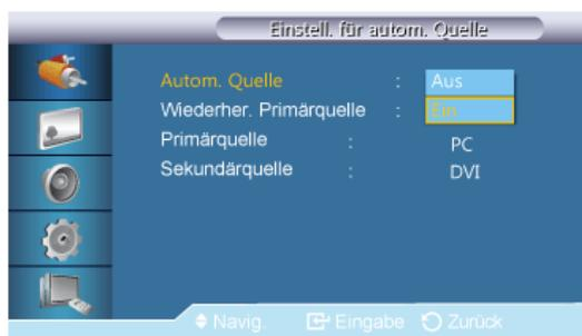
Wenn **Autom. Quellenwahl** aktiviert (**Ein**) ist, wird die Videoquelle der Anzeige automatisch nach einem aktiven Videosignal durchsucht.
