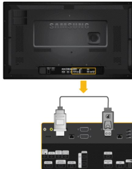
Verbinden Sie den [*MAGICINFO OUT*]-Anschluss über ein DP/HDMI-Kabel mit dem [*HDMI IN 2 (MAGICINFO)*]-Anschluss des Geräts.
