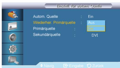
Wenn **Primärquellenauswahl** aktiviert (**Ein**) ist, werden nur **Primärquelle** und **Sekundärquelle** nach einer aktiven Videosignalquelle durchsucht.
