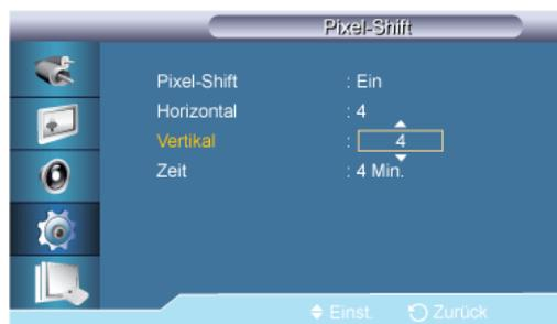
Hiermit wird festgelegt, um wie viele Pixel der Bildschirm vertikal verschoben werden soll.
