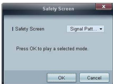
Die Funktion **Safety Screen** verhindert das Einbrennen, wenn der Bildschirm eines Anzeigegeräts für einen längeren Zeitraum ein statisches Bild anzeigt.
