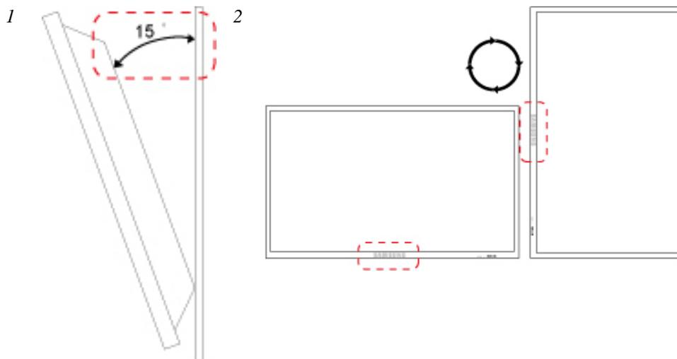
1. Das Gerät kann bis zu einem Winkel von maximal 15 Grad zur Wand gekippt werden.
