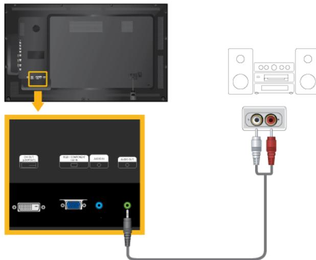
1. Verbinden Sie den [AUDIO OUT]-Ausgang am LCD-Bildschirm mit den AUX L, R-Anschlüssen am Audiosystem.
