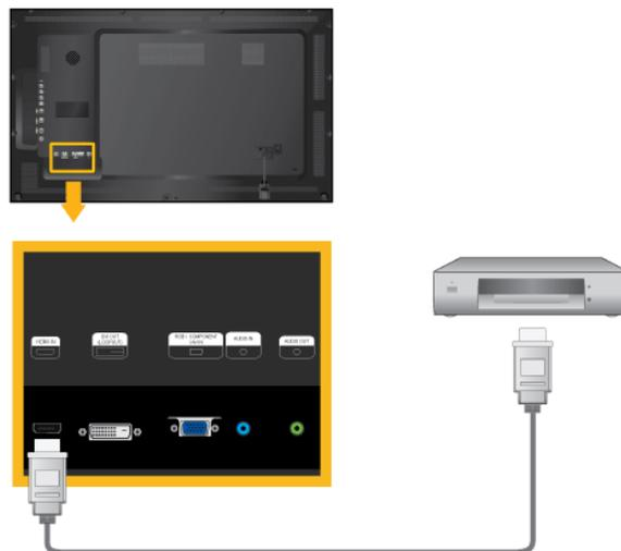
1. Schließen Sie Signalquellen wie Blu-ray/DVD-Geräte mit dem HDMI-Kabel an den [HDMI IN]-Anschluss des LCD-Bildschirms an.
