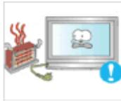
▶ **Halten Sie Heizvorrichtungen so weit wie möglich vom Netzkabel und dem Gerät entfernt.**
