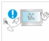
▶ Ziehen Sie den Netzstecker niemals bei eingeschaltetem Gerät aus der Steckdose.
