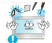
▶ Führen Sie weder Metallgegenstände wie Besteck, Münzen, Stifte oder Stäbchen, noch leicht entflammbare Gegenstände wie Papier oder Streichhölzer (durch die Belüftungsschlitze und Ein-/Ausgangsanschlüsse usw.) ins Innere des Geräts.
