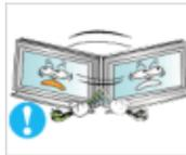
▶ Heben Sie das Gerät nicht an und bewegen Sie es nicht nach vorn/hinten/links/rechts, wenn Sie es nur am Netzkabel oder den Signalkabeln halten.
