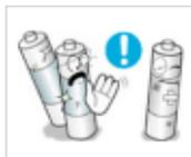
▶ Verwenden Sie nur die vorgeschriebenen Standardbatterien und setzen Sie niemals gleichzeitig neue und gebrauchte Batterien ein.
