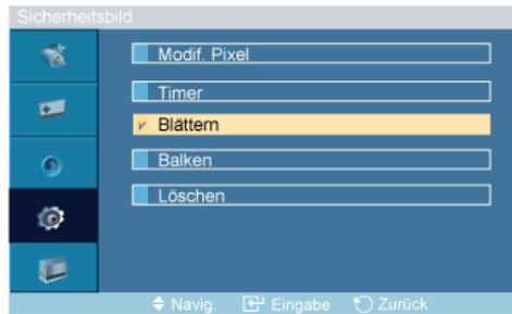
Diese Funktion verhindert Nachbilder auf dem Bildschirm, indem sie alle Pixel des Plasma-bildschirms nach einem bestimmten Muster verschiebt.
