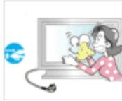
▶ Trennen Sie vor dem Reinigen des Geräts das Netzkabel, und reinigen Sie es dann mit einem weichen und trockenen Tuch.
