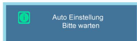
Die Werte für **Fein**, **Grob** und **Position** werden automatisch eingestellt. Wenn Sie die Auflösung über die Systemsteuerung ändern, wird die Funktion automatisch ausgeführt.
