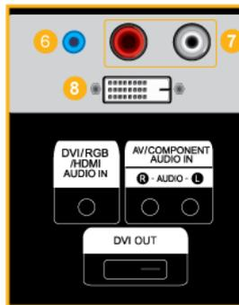
**6** *DVI/RGB/HDMI AUDIO IN (PC/DVI/HDMI Audioanschluss (Eingang))*
