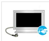
▶ Wenn Sie das Gerät über einen längeren Zeitraum nicht verwenden, ziehen Sie das Netzkabel aus der Steckdose.
