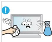
▶ Spritzen Sie beim Reinigen des Geräts kein Wasser direkt auf das Gehäuse.
