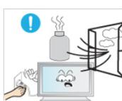
▶ Bei Austritt von Gas berühren Sie weder das Gerät noch den Netzstecker. Lüften Sie die Räumlichkeiten sofort.
