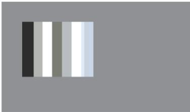
**Löschen:** Diese Funktion verhindert Nachbilder auf dem Bildschirm, indem sie ein rechteckiges Muster auf dem Bildschirm verschiebt.
