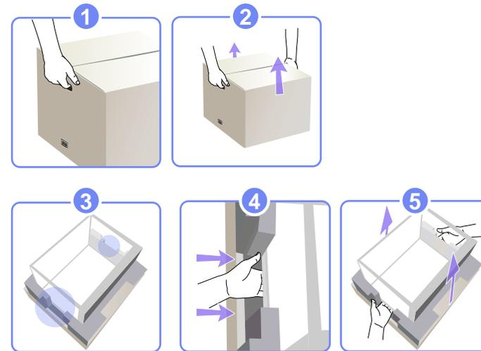
3. Überprüfen Sie die Komponenten und entfernen Sie das Styropor und Kunststoffhülle.
