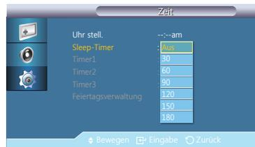
**Sleep-Timer:** Hiermit stellen Sie das Gerät so ein, dass es nach einem angegebenen Zeitraum automatisch ausgeschaltet wird.
