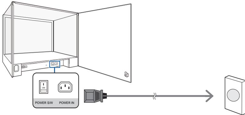
1. Schließen Sie das Netzkabel an das Gerät und die Wandsteckdose an.
