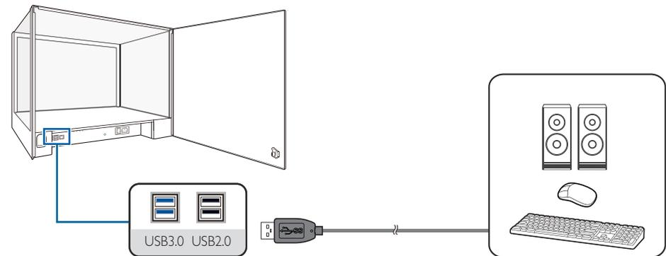
1. Schließen Sie ein USB-Gerät, z. B. Tastatur, Maus oder Lautsprecher hinten an den **USB**-Anschluss an.
