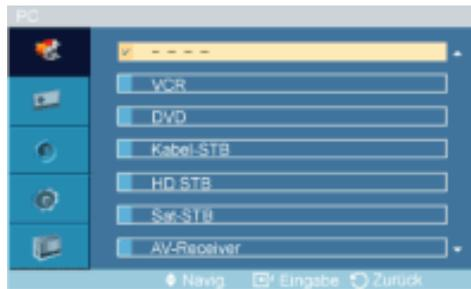
Vergeben Sie an das an die Eingangsbuchsen angeschlossene Eingabegerät einen Namen, um die Auswahl der Signalquelle zu vereinfachen.
