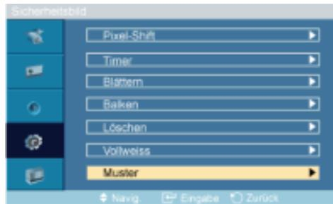
Diese Funktion verhindert Nachbilder auf dem Bildschirm, indem sie ein diagonales, im Bildschirm gespeichertes Muster auf dem Bildschirm verschiebt.
