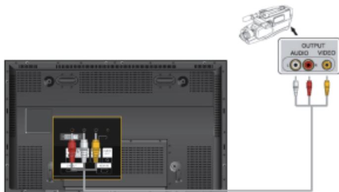
1. Suchen Sie die AV-Ausgangsbuchsen am Camcorder. Sie befinden sich normalerweise seitlich am Camcorder oder auf dessen Rückseite. Verbinden Sie den AV/COMPONENT AUDIO IN [L-AUDIO-R]-Eingang am Plasmabildschirm mit den AUDIO OUTPUT-Anschlüssen am Camcorder.
