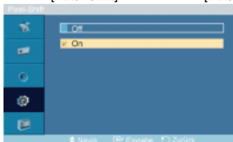
Um Nachbilder auf dem Bildschirm zu verhindern, können Sie mit dieser Funktion dafür sorgen, dass die Pixel im Abstand von einer Minute auf dem Plasmabildschirm horizontal oder vertikal verschoben werden.
