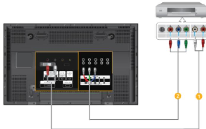
1. Verbinden Sie den AV/COMPONENT AUDIO IN [L-AUDIO-R]-Anschluss am Plasma-bildschirm mit den AUDIO OUT-Anschlüssen am DVD-Player.
