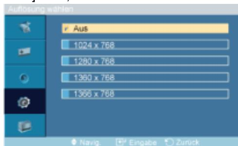
Wenn das Bild bei einer Einstellung der Grafikkartenauflösung auf 1024 x 768 bei 60 Hz, 1280 x 768 bei 60 Hz, 1360 x 768 bei 60 Hz oder 1366 x 768 bei 60 Hz nicht ordnungsgemäß angezeigt wird, können Sie mit dieser Funktion (Resolution Select) dafür sorgen, dass das Bild in der angegebenen Auflösung angezeigt wird.
