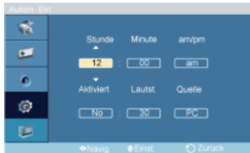
Hiermit wird der Plasmabildschirm zu einer bestimmten Zeit automatisch eingeschaltet. Hiermit stellen Sie den Modus und die Lautstärke des Plasmabildschirms ein, wenn dieser automatisch angeschaltet wird.
