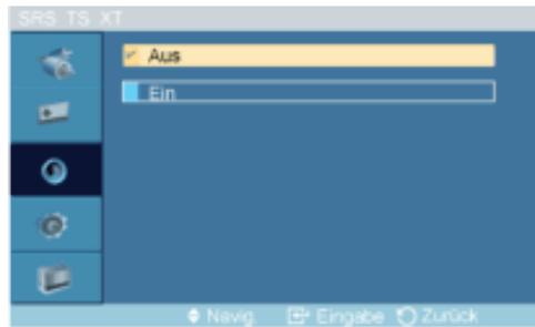
SRS TS XT ist ein patentiertes SRS-Verfahren für die Wiedergabe von 5,1-Mehrkanalton über zwei Lautsprecher. Mit TruSurround kommen Sie mit jedem Stereo-System mit zwei Lautsprechern, auch den internen Gerätelautsprechern, in den Genuss überzeugender Virtual Surround-Effekte. Es ist vollständig kompatibel mit allen Mehrkanalformaten.
