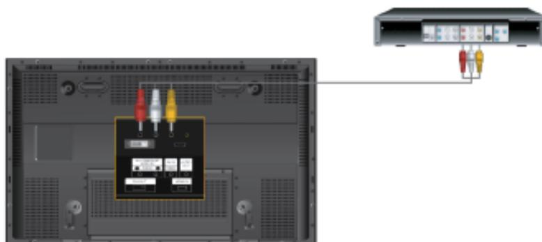
1. Verbinden Sie den Anschluss der DVD, VCR (DVD / DTV-Set-Top Box) mit dem [R-AUDIO-L] -Anschluss am Gerät.
