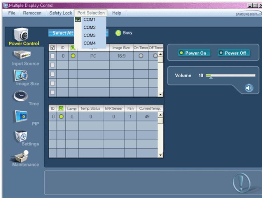
1. Die Multiple Display Control ist ursprünglich auf COM1 eingestellt.
