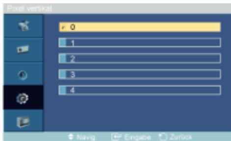
Hiermit wird festgelegt, um wie viele Pixel der Bildschirm vertikal verschoben werden soll.
