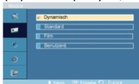
Der Plasmabildschirm verfügt über vier automatische Bildeinstellungen ("**Dynamisch**", "**Standard**", "**Film**" und "**Benutzerd.**"), die werksseitig eingestellt werden.
