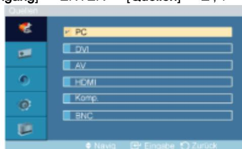
Wird zum Auswählen von **PC**, **DVI** oder einer anderen an den Plasmabildschirm angeschlossenen externen Signalquelle verwendet. Wählen Sie hiermit den gewünschten Bildschirm aus.
