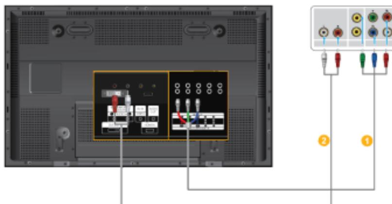
1. Verbinden Sie den BNC / COMPONENT IN -  $P_R$ ,  $Y$ ,  $P_B$ -Anschluss am Plasmabildschirm und den  $P_R$ ,  $Y$ ,  $P_B$ -Anschluss am DVD-Player über ein Komponentenkabel miteinander.
