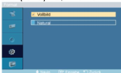
Das **Format** kann ausgewählt werden, um ein segmentiertes Bild anzuzeigen.
