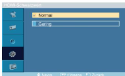
Wenn Sie eine DVD oder Set-Top-Box über HDMI an Ihr Fernsehgerät anschließen, kann es zu einer Verschlechterung der Bildqualität kommen. Dies drückt sich, je nach angeschlossenen externen Gerät, in einer Zunahme des Schwarzwerts, geringem Kontrast und Farbfehlern usw. aus. Stellen Sie in diesem Fall die Bildqualität des Fernsehgeräts ein, indem Sie den **HDMI-Schwarzwert** konfigurieren.
