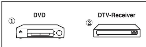
An die **COMPONENT IN** können Geräte angeschlossen werden, die über einen DVD- oder DTVReceiverausgang verfügen. (480i, 480p, 576i, 576p, 1080i)
