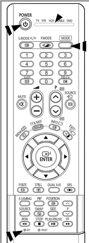
*Im Lieferumfang Ihres Fernsehers ist eine Universal-Fernbedienung enthalten. Mit der Fernbedienung dieses Fernsehers können neben diesem Gerät auch Videorecorder, Kabelreceiver, DVD-Player und einige Set-Top-Boxen von Samsung gesteuert werden (auch Videorecorder, Kabelreceiver und DVD-Player anderer Hersteller werden unterstützt).*
