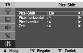
Dieses Gerät ist mit Einbrennschutz-Technologie ausgestattet, um die Möglichkeit des Einbrennens des Monitorbildes zu verringern. Diese Technologie ermöglicht das Einstellen von vertikalen (Pixel vertikal) und horizontalen (Pixel horizontal) Bildbewegungen. Die Zeiteinstellung ermöglicht das Programmieren der Dauer zwischen Bildbewegungen in Minuten.
