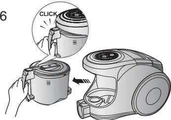
Vor dem erneuten Gebrauch den Staubbehälter ordnungsgemäß in den Staubsauger einführen bis es hörbar "klickt".
