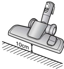
Wenn die Kontrollleuchte des Filters rot aufleuchtet während Sie die Saugöffnung 10 cm über dem Boden halten, muss der Filter gereinigt werden.
