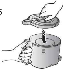
Schließen Sie den Staubbehälter indem Sie die Pfeile auf dem Staubbehälter und auf dem Deckel bündig zueinander ausrichten.
