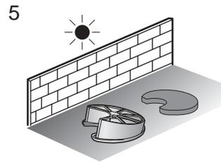
Den Schwamm und den Filter mindestens 12 Stunden im Schatten trocknen lassen.
