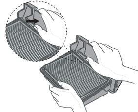
Drücken Sie wie in der Abbildung die Lasche leicht nach oben um den HEPA-Filter vom Griffteil zu lösen.
