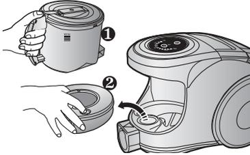
Sowohl den Staubbehälter als auch die filterkammer entfernen.
