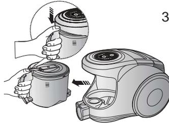
Drücken Sie den Knopf und entfernen Sie den Staubbehälter.
