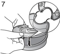
Bevor Sie die Filterkammer wieder einführen, muss die Lasche des Deckels der Filterkammer wieder mit der Aussparung geschlossen werden.
