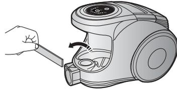
Den Motorschutzfilter aus dem Staubsauger entfernen und reinigen. Anschließend wieder montieren.
