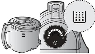
Wenn der Staub im Staubbehälter die Markierung [DUST FULL] erreicht oder die Leuchte während des Betriebs aufleuchtet, muss der Staubbehälter geleert werden.
