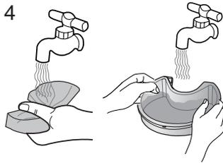
Den Schwamm und den Filter der filterkammer mit Wasser reinigen.
