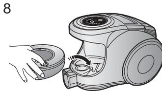
Die komplette Filterkammer in den Staubsauger einführen.
