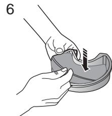
Den Schwamm wieder in der filterkammer einführen.
