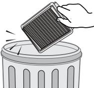
Den HEPA-Filter reinigen.
