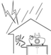
**Schalten Sie das System bei Gewitter sofort aus, und ziehen Sie das Netzkabel aus der Wandsteckdose.**
