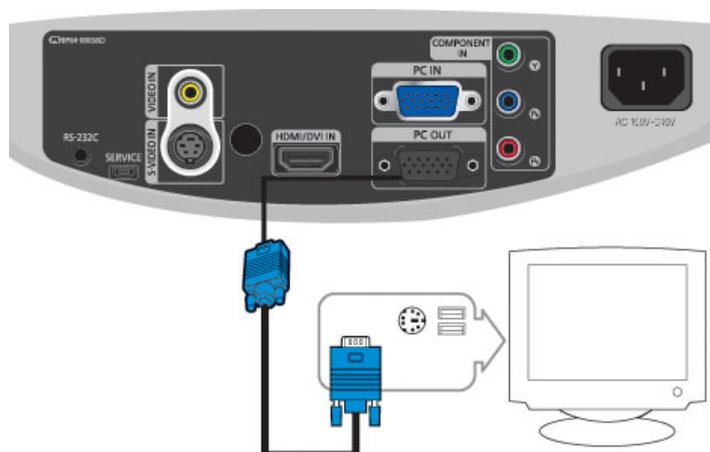
**01** – Bei Verwendung eines (analogen) D-Sub-Ausgangs über ein anderes Anzeigegerät (Monitor, Fernseher usw.). Schließen Sie den PC OUT-Anschluss des Projektors mit einem D-Sub-Kabel an den D-Sub-Anschluss des Anzeigegeräts an.
