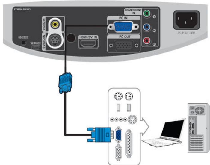
**01** Verbinden Sie den [PC IN]-Anschluss auf der Rückseite des Projektors mithilfe eines PC-Videokabels mit dem Monitorausgang am PC.
