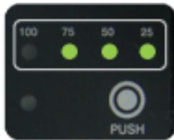
Hier wird die Restladung des Akkus als Prozentsatz angezeigt. Zur Kontrolle der Restladung des Akkus drücken Sie die Taste unten rechts vom Batteriefach. Die grünen LEDs zeigen die Restladung an, und sie werden nach etwa fünf (5) Sekunden automatisch abgeschaltet.
