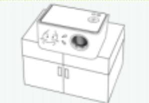
**Achten Sie beim Aufstellen des Geräts in einem Schrank oder auf einem Regal darauf, dass die Vorderseite des Geräts nicht aus dem Schrank bzw. Regal herausragt.**
