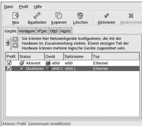
Abbildung 19-21. Beispiel eines Netzwerkgerätalias
