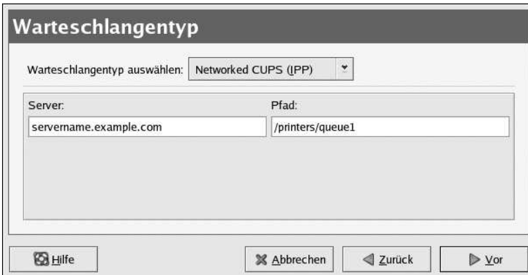
Abbildung 36-5. Hinzufügen eines CUPS (IPP) Netzwerkdruckers
