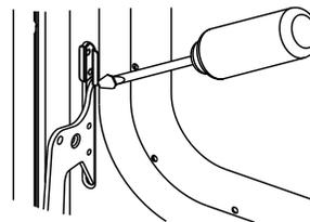
2. Disjoindre l'attache et la retirer de la fente de charnière avant du châssis. Veiller à ne pas égratigner le fini.
