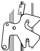
4. Insérer l'attache de la butée de la porte, surface en haut de la fente de charnière du châssis, puis pousser le bas de l'attache jusqu'à ce que les rebords soient en affleurement avec l'avant du châssis.
