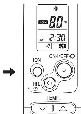
Le mode d'ionisation (ION) est utilisé pendant le fonctionnement pour générer des ions négatifs qui rafraîchissent l'air dans la pièce.
