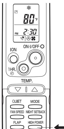
Le mode de fonctionnement à haute puissance (HIGH POWER) peut être utilisé pour augmenter la sortie de l'élément intérieur pour tous les modes de fonctionnement sauf le mode automatique.
