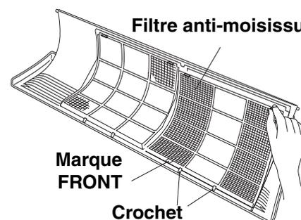
2. Laisser le bord de la grille d'arrivée d'air glisser dans la partie supérieure de l'appareil, puis insérer-la à fond à l'intérieur.
