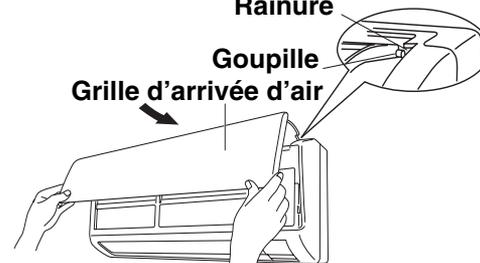
3. Appuyer sur les coins inférieurs droit et gauche, ainsi que sur le centre de la grille d'arrivée d'air pour l'attacher à l'appareil.
