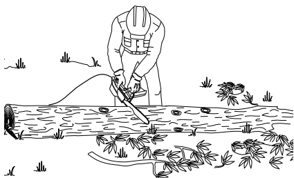
Figura 16 - Trozado del tronco completamente apoyado en el suelo
