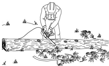
Figure 15 - Tronçonnage d'une bille qui repose entièrement au sol
