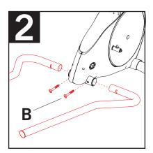
STEP 2: ATTACH LEFT & RIGHT GUIDE RAILS.
