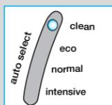
Au terme du programme, le témoin bleu « clean » (propre) s'allume. Dégager le rasoir en appuyant sur le bouton « start cleaning » (début du nettoyage).
