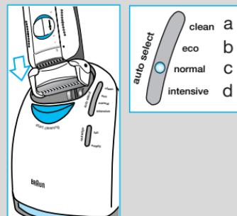
Si el sistema ha seleccionado uno de los tres programas de limpieza, el proceso no comenzará hasta que presione el botón de «inicio de la limpieza» (2). Esto asegura la máquina de afeitar en la unidad e inicia el proceso de limpieza.
