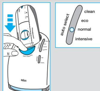
**Los procesos de limpieza en el Clean&Renew™ no deben ser interrumpidos. Mientras que la máquina de afeitar se está secando, las piezas de metal pueden calentarse. También si la máquina de afeitar se saca prematuramente y no está seca, su programación electrónica puede dañarse.**
