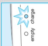
Una luz verde de carga (16) muestra que se está cargando la máquina de afeitar. Cuando la batería se carga completamente, la luz de carga se apaga y únicamente se enciende de nuevo cuando la batería mantiene su capacidad al máximo.
