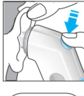
4. Coloque la sonda de forma suave en el oído, luego presione el botón «start» puesta en marcha (4). Una breve señal «beep» le indicará que el proceso de medida se ha iniciado.
