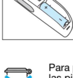
Abre el compartimento de pila. Quitar la pila usada y reemplazarla por la nueva teniendo cuidado de que los polos están en el sentido correcto. Deslice la tapa del compartimento de pila hasta que encaje en su sitio.
