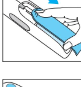
El termómetro lleva instalada una pila de 1,5V tipo AAA (LR 03). Para un mejor rendimiento, recomendamos las pilas alcalinas Duracell®. Coloque pila nueva cuando aparece el símbolo pila en la pantalla.
