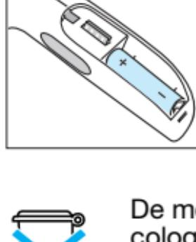
Abra o compartimento de pilha. Retire a pilha gasta e substitua por una nova pilha. Coloque a tampa do compartimento de pilha novamente até encaixar.
