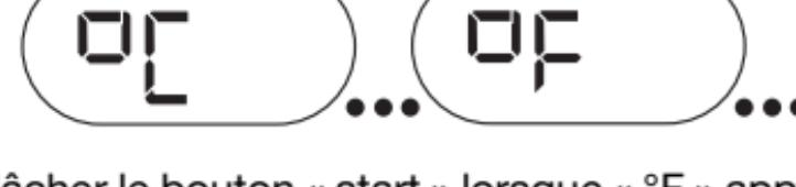
Relâcher le bouton « start » lorsque « °F » apparaît à l'écran. Il y a alors un court bip sonore confirmant le changement d'échelle de température, puis le thermomètre s'éteint automatiquement.
