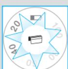
Udskiftningssymbolet minder dig under de næste 7 barberinger om at udskifte kassetten med skæreblade og lamelknife. Derefter nulstiller barbmaskinen automatisk displayet.
