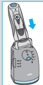
Rengöringsstationen laddar nu automatiskt rakapparaten vid behov. Rakapparaten hygieniska tillstånd analyseras också och en av rengöringsprogrammets följande indikatorer ⑤ börjar lysa:
