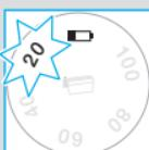
Kırmızı düşük şarj göstergesi makine açıldığında pilin azaldığını belirtmek için yanıp söner. Bu durum, pilde 2 - 3 tıraş için yetecek kadar güç kaldığı anlamına gelir.
