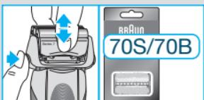
Una volta sostituito il sistema di rasatura, tenere premuto il pulsante di reset ⑯ e con una penna a sfera per almeno 3 secondi e azzerare il contatore.
