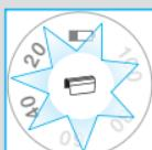
Byt-utsymbolen är till för att påminna dig om att du under de kommande 7 rakningarna bör byta ut skärblads- och saxkassetten. Rakapparaten återställer därför displayen automatiskt.
