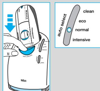
**Los procesos de limpieza en el Clean&Charge no deben ser interrumpidos. Mientras que la máquina de afeitar se está secando, las piezas de metal pueden calentarse. También si la máquina de afeitar se saca prematuramente y no está seca, su programación electrónica puede dañarse.**
