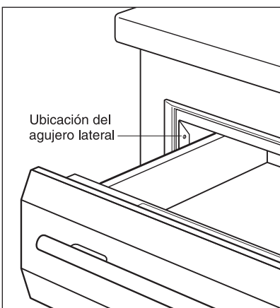
Instalación del cajón calentador
