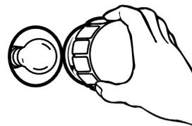
3. Tourner l'ampoule dans le sens antihoraire et l'enlever de la douille.
