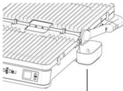
La taza recolectora de grasa se muestra correctamente colocada.
