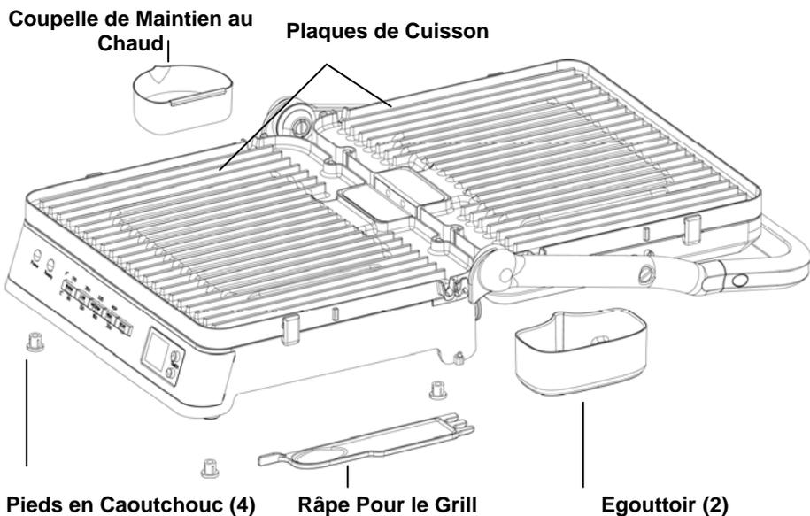
**Plaques de cuisson :** Les plaques de cuisson amovibles et réversibles supérieure et inférieure sont interchangeables. Les plaques de cuisson sont réversibles avec une surface pour les grillades, dentelée sur une face et une surface de cuisson, plate de l'autre côté. Les deux plaques de cuisson ont un revêtement antiadhésif pour un nettoyage facile.
