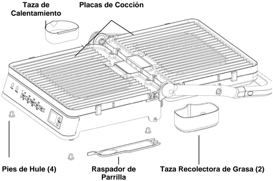
**Placas de cocción:** Las placas de cocción desprendibles y reversibles superiores e inferiores son intercambiables. Las placas de cocción son reversibles con una superficie para asar acanalada en un lado y una superficie tipo plancha de calentamiento plana por el otro lado. Ambas placas de cocción cuentan con una superficie antiadherente para facilitar su limpieza.
