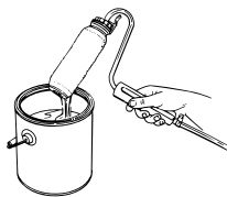
1. Nettoyage du revêtement du rouleau.
