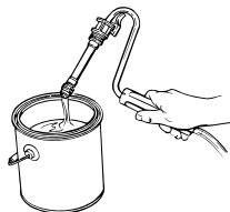
2. Élimination de la peinture se trouvant dans le tuyau flexible.
