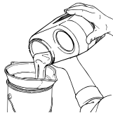
3. Vidage du réservoir de peinture. 4. Nettoyage du tuyau flexible.
