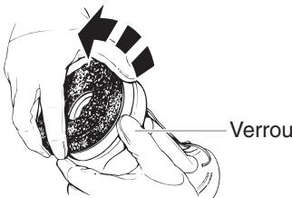
2. Installez la nouvelle meule en la tournant dans le sens des aiguilles d'une montre tout en appuyant sur le verrou. Serrez la meule à la main.
