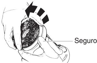
2. Mientras presiona el seguro del disco en la parte inferior de la unidad, enrosque el disco nuevo en la unidad en el sentido de las manecillas del reloj y ajústelo a mano.
